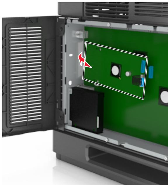
**Remarque :** Inclinez le port ISP au-dessus du support en plastique de sorte que les tiges des connecteurs placés en saillie traversent l'ouverture ISP installée sur le boîtier.
