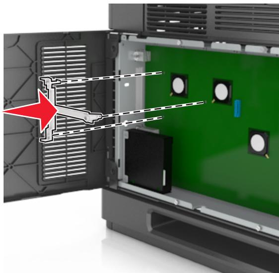
**Remarque :** Vérifiez que le support en plastique est bien enclenché et qu'il est correctement placé sur le boîtier.
