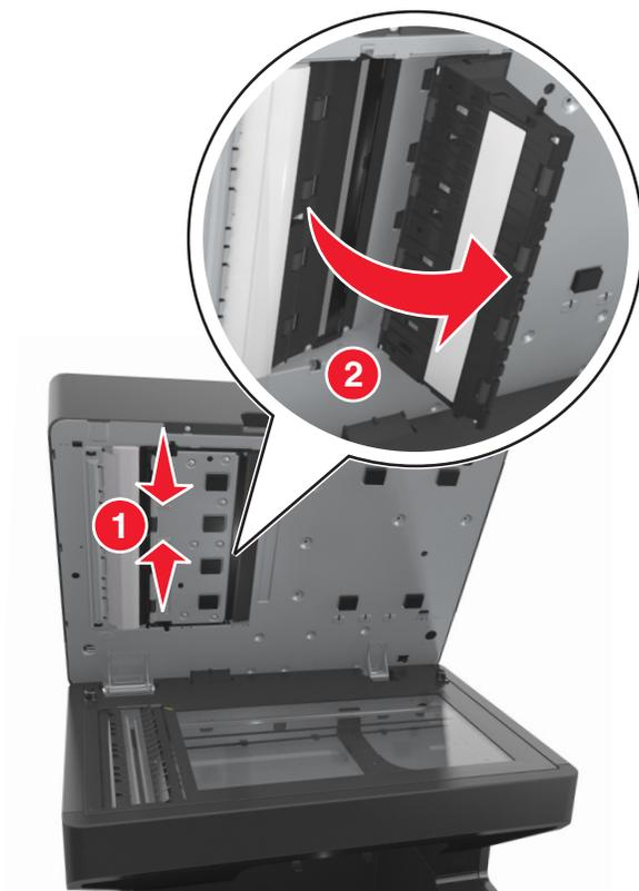
5 Essuyez la vitre de scanner du dispositif d'alimentation automatique située sous la porte de ce dernier.
