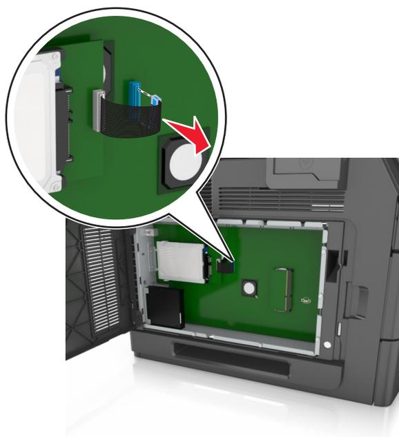
**3** Retirez les vis en maintenant le disque dur de l'imprimante en position.
